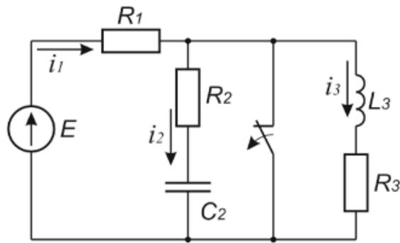
Рисунок 1 - Схема 1 ( $E=25\text{В}$ ,  $R_1=100(\text{Ом})$ ,  $R_2=250(\text{Ом})$ ,  $R_3=100(\text{Ом})$ ,  $C=5\text{мкФ}$ ,  $L=3\text{мГн}$ ).
