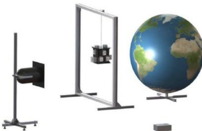
Рис. 3. Магнитная рамка (имитатор магнитного поля Земли) с подвесом, имитатор Земли, имитатор Солнца
