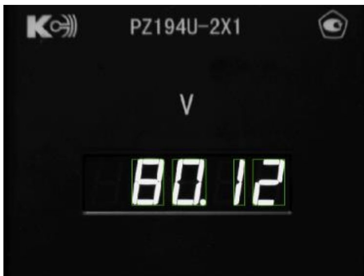
Рисунок 9 – Распознавание данных с цифрового КИП
