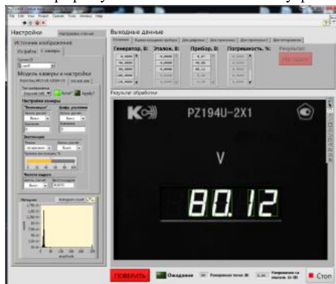
Рисунок 7 – Фотография установленного КИП в зону фиксации данных
