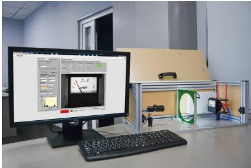
Рисунок 6 – Система фиксации данных КИП
