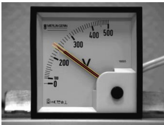
Рисунок 10 – Фиксация программой угла наклона стрелки КИП
