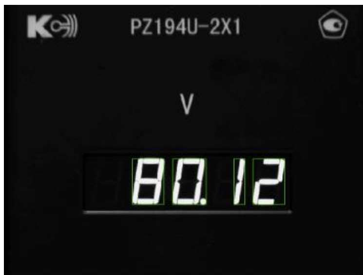
Рисунок 9 – Распознавание данных с цифрового КИП
