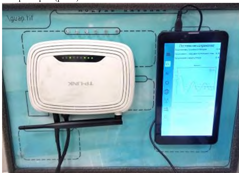
Рисунок 2 - Сервер киберфизической системы ГЭ
