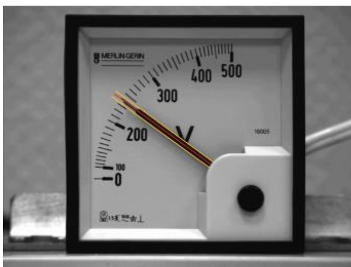
Рисунок 10 – Фиксация программой угла наклона стрелки КИП
