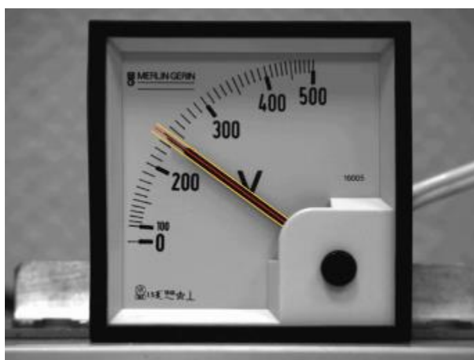
Рисунок 10 – Фиксация программой угла наклона стрелки КИП
