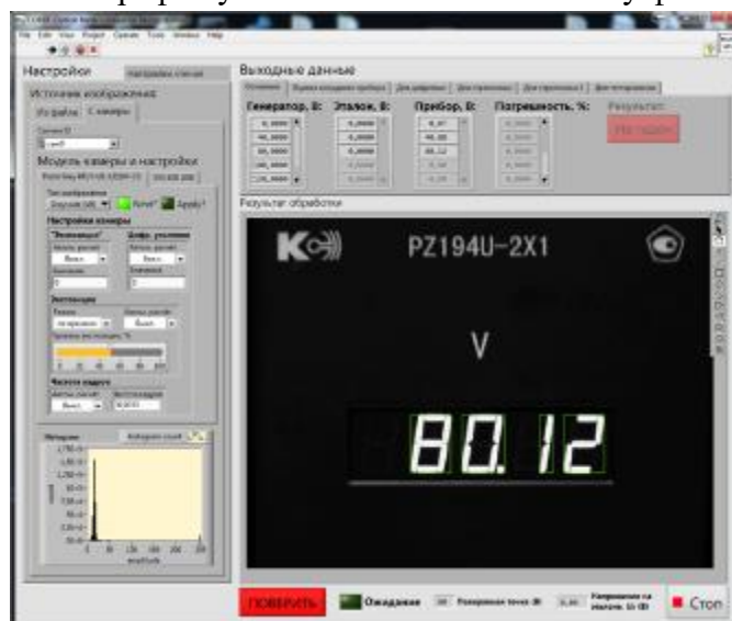
Рисунок 7 – Фотография установленного КИП в зону фиксации данных
