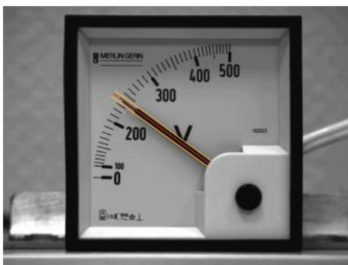
Рисунок 10 – Фиксация программой угла наклона стрелки КИП
