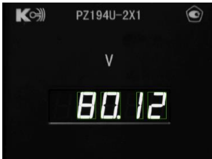
Рисунок 9 – Распознавание данных с цифрового КИП
