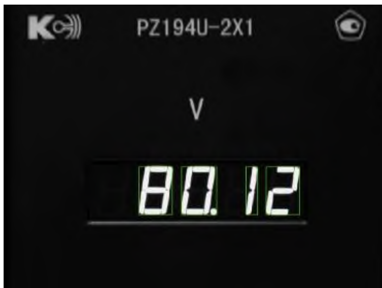
Рисунок 9 – Распознавание данных с цифрового КИП
