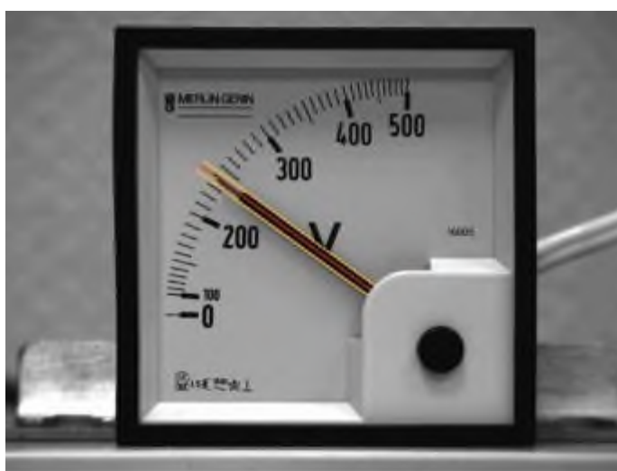
Рисунок 10 – Фиксация программой угла наклона стрелки КИП
