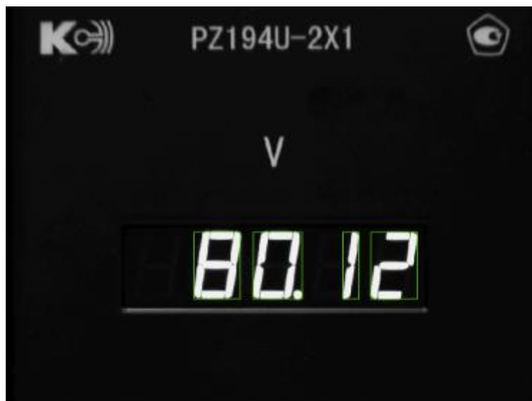
Рисунок 9 – Распознавание данных с цифрового КИП
