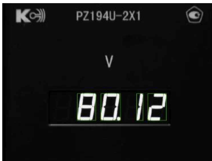
Рисунок 9 – Распознавание данных с цифрового КИП
