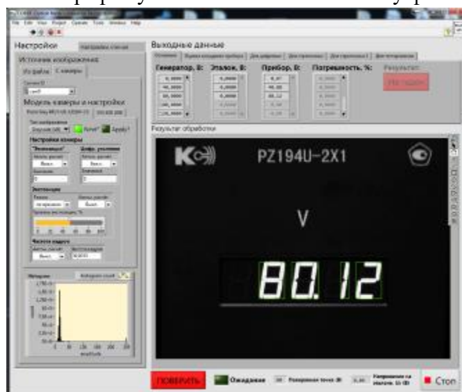
Рисунок 7 – Фотография установленного КИП в зону фиксации данных
