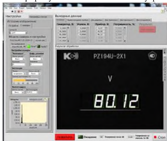
Рисунок 8 - Испытание работы КИП киберфизической системы
