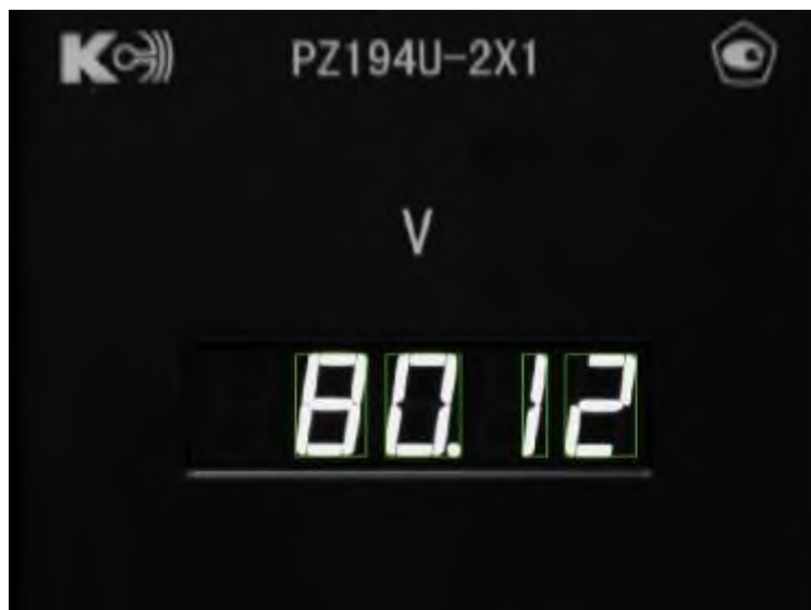
Рисунок 9 – Распознавание данных с цифрового КИП
