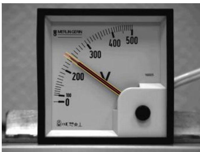
Рисунок 10 – Фиксация программой угла наклона стрелки КИП
