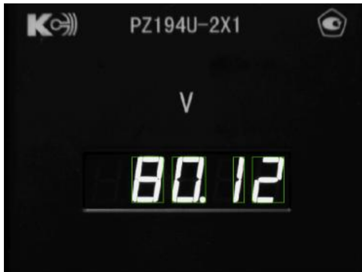
Рисунок 9 – Распознавание данных с цифрового КИП
