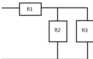
6. Три сопротивления подключены параллельно. Напряжение на участке цепи равно 18 В. Найти общую силу тока в цепи.
