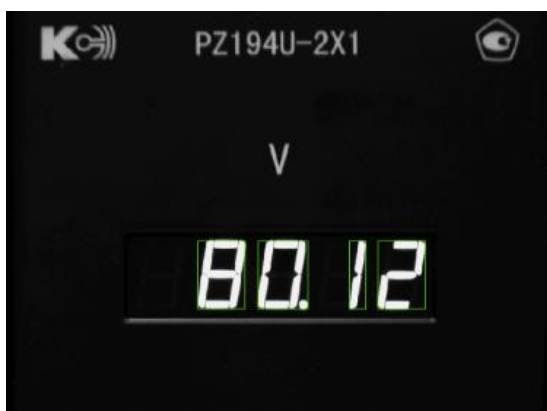
Рисунок 9 – Распознавание данных с цифрового КИП
