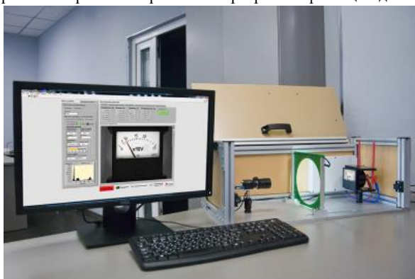
Рисунок 6 – Система фиксации данных КИП
